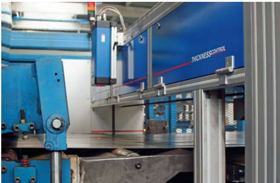
Abb. 6: Komplettvermessung mit Längenprotokoll durch ASCOspeed
