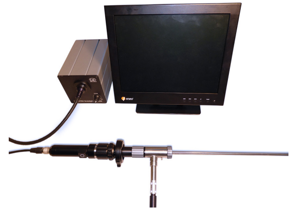
Abb. 17 Endmontage Endoskop mit Analoger Kamera, Laptop und Lichtquelle
